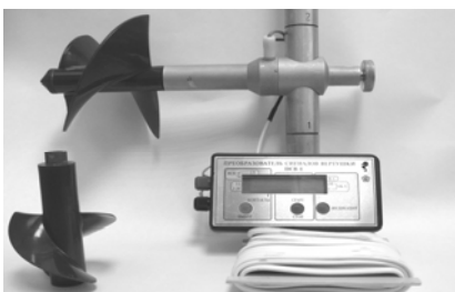
Рис. 5. Измеритель скорости потока ИСП-1, ИСП-1М, ИСП-2, ИСТ (ФГУП «Гидрометприбор», г. Санкт-Петербург) (фото автора)
