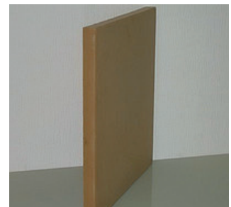
3-расм. Серпентин асосидаги керамик плита
