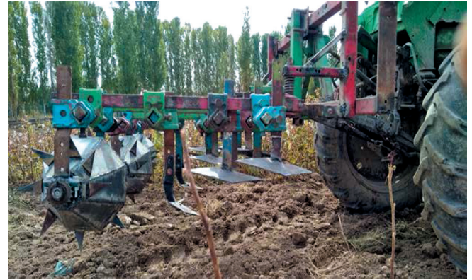
4-расм. Ғўза қатор ораси тупроғига кузги бугдой экиш олдидан қатламли ва сифатли ишлов берадиган техник восита
