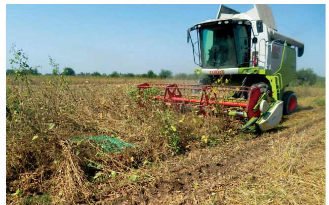
2-расм. "Доминатор-130" комбайни билан сояни йиғиштириш жараёни
