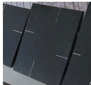
2-расм. Карбид кремний асосидаги керамик плита
