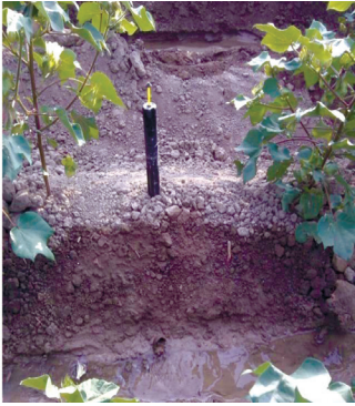
4-расм. Тупроқ намланганлигини билдирувчи детекторнинг юқорига кўтарилиши. Унда қизил рангли, чапта сариқ рангли детектор
