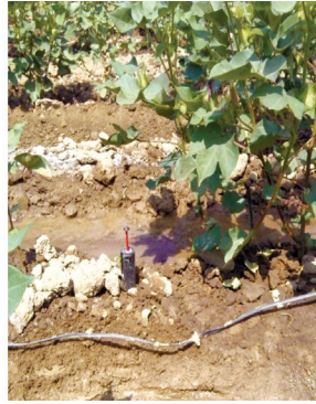
4-расм. Тупроқ намланганлигини билдирувчи детекторнинг юқорига кўтарилиши. Унда қизил рангли, чапта сариқ рангли детектор
