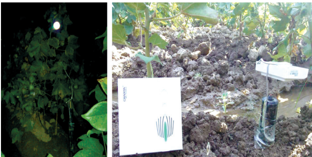
5-расм. Веттинг фронт детектор асбобига ўрнатилган қўшимча қурилмалар яъни ёритувчи фонарь ва сигнализация орқали тупроқ намлигини назорат қилиш
