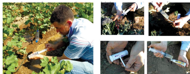
2-расм. Сувли сўрим олинishi ва унинг таҳлил қилиниш жараёни
