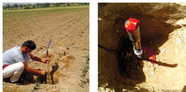
3-расм. Веттинг фронт детектор (WFD) асбобини далага ўрнатиш жараёни
