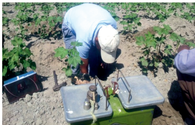
1-расм. Кузги буғдойдан кейин ҳар хил чуқурликларда такрорий экин мош, соя ва сули экинлари етиштирилгандан сўнг ғўза даласида суе ўтказувчанлик аниқлаш жараёни
