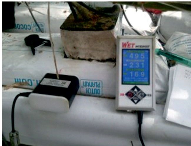
3-расм. Гидропоника материалларини намлигини ва ҳароратини аниқлаш
