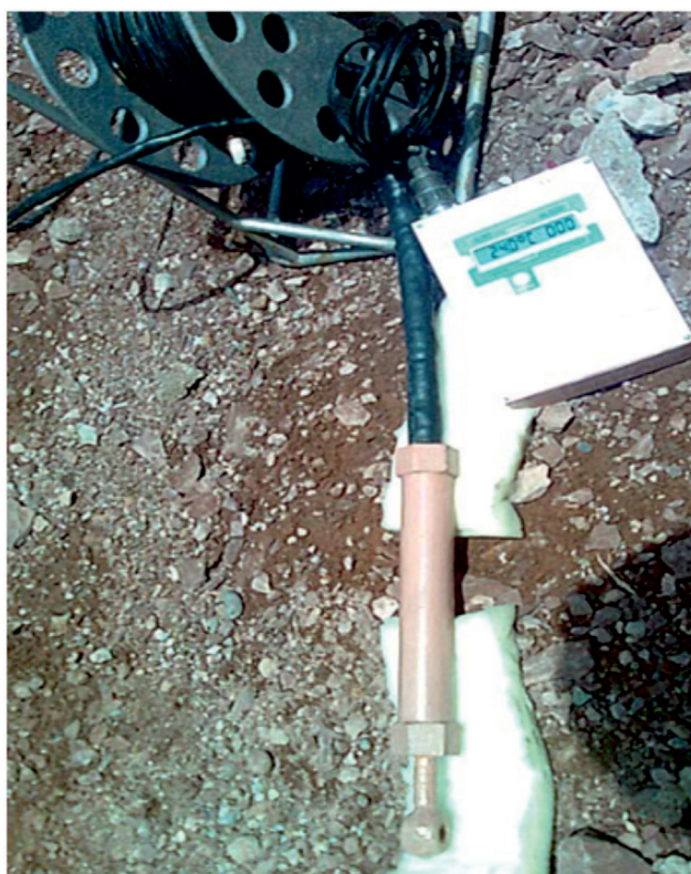
Рис. 1. Кондуктометр в сборе
