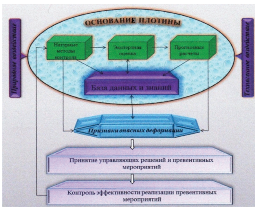
Рис. 1. Общая схема системы мониторинга основания плотины
