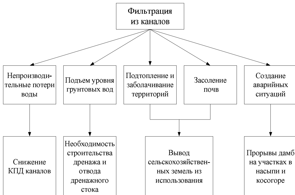
Рисунок 1 – Последствия фильтрации из каналов
