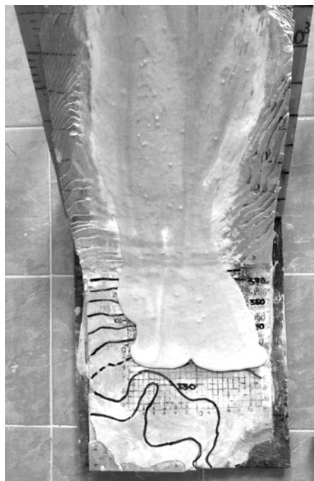
Рис. 1. Модель лавинобора № 22 в Хибинах (вид сверху) с модельной лавиной из древесных оливок, смоченных жидким мылом
