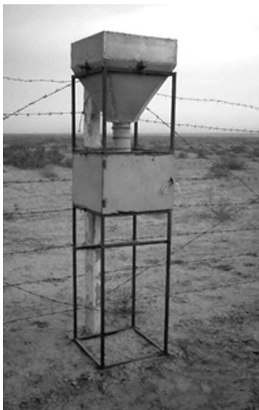
Рис. Пыленакопитель, использованный на полуострове Челекен
