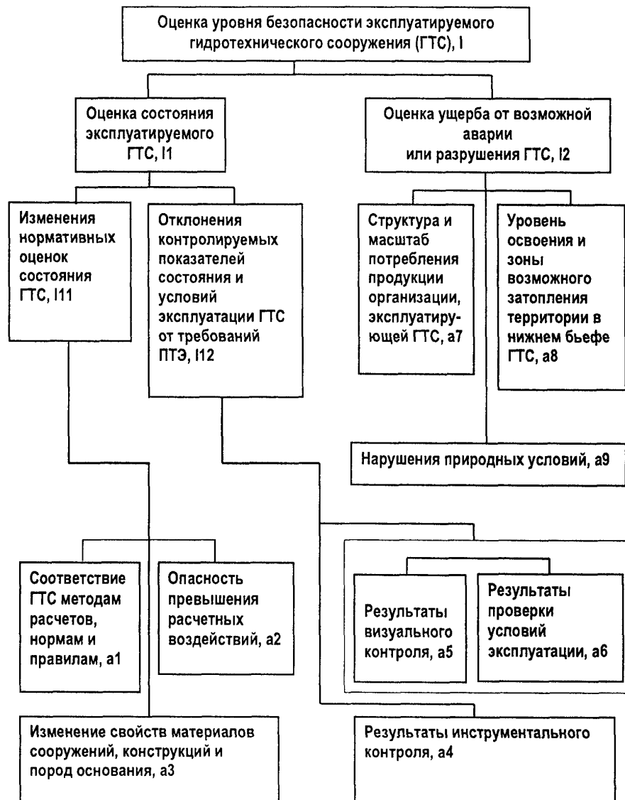
Рис. 1. Структура факторов безопасности и схема оценки их влияния на безопасность эксплуатируемых ГТС
