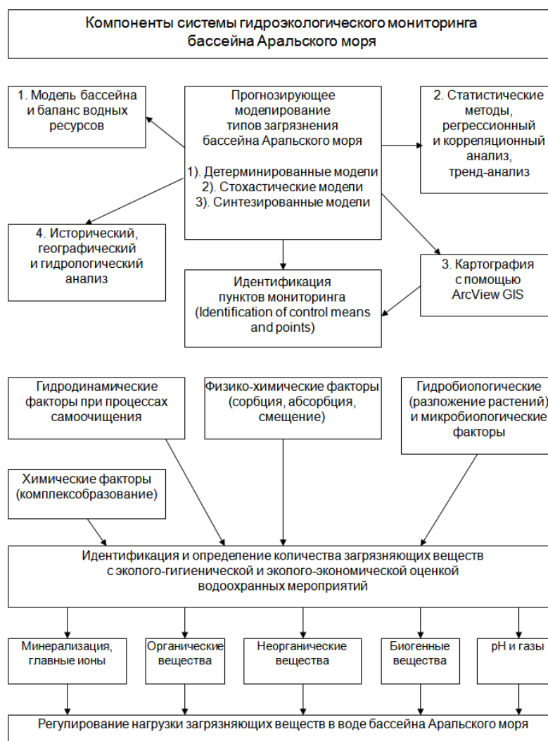
Рис. 2. Входящие и выходящие компоненты модели бассейна Аральского моря
